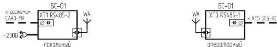
Рисунок Л.3 – Объединение систем в единую сеть по радиоканалу.
