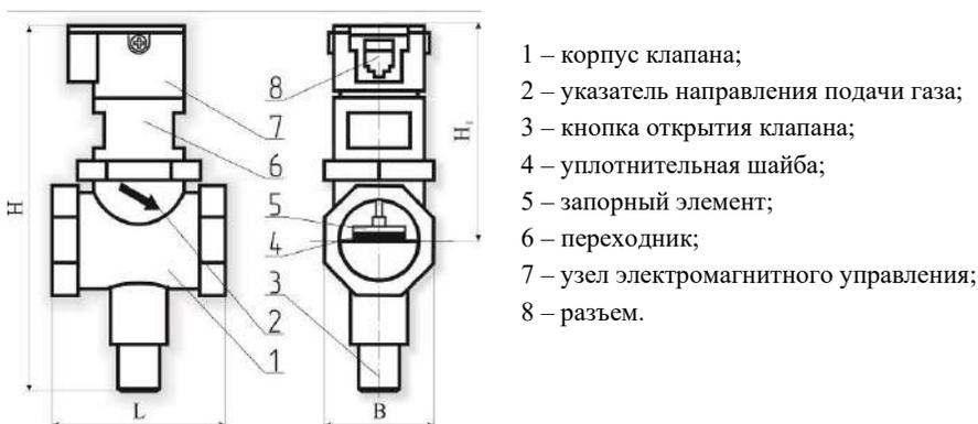
Рисунок 2 – Внешний вид клапана КЗЭУГ.
