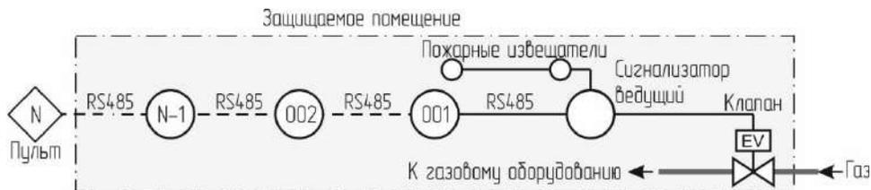
Рисунок 16 – Система с групповой защитой и RS485
